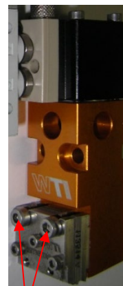
Deux vis de montage de la buse haute vitesse UFD
