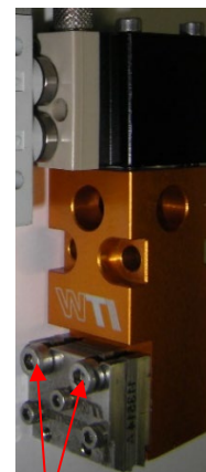
UFD High-Speed-Düsen haben zwei Befestigungsschrauben
