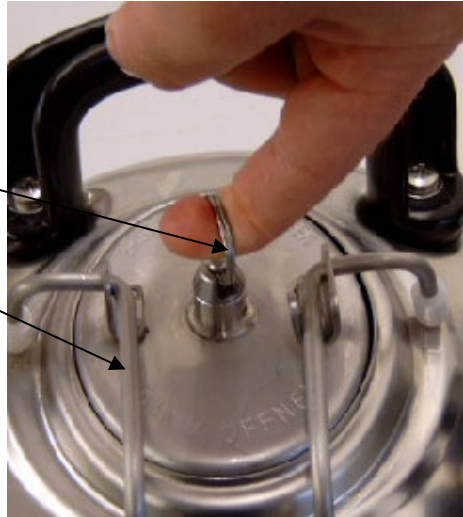
Bild: Druckbehälter, Sicherheitsventil
