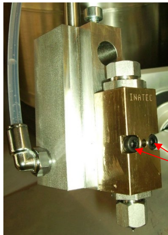
Bild: Auftragsmodul auswechseln
