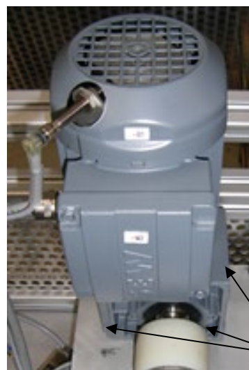
Die 4 Schrauben lösen
