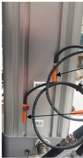
Image : Détecteur de proximité pour contrôle de niveau sur le vérin pneumatique
