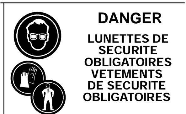
Il est impératif de SE PROTEGER LES YEUX pour le personnel travaillant autour d'un système d'application de colle chaude! Il est nécessaire de porter des lunettes de sécurité à écran latéral conformes
